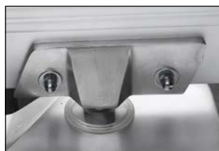
Posibilidad de ajuste plato cuchilla
