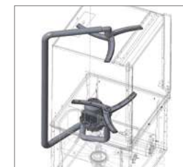
Bomba de doble flujo.
