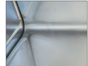
Cantos redondeados para reducir la acumulación de suciedad.
