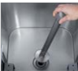
Sistema de desagüe para renovación de agua.
