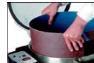
Paredes abrasivas de fácil reemplazo
