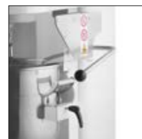
Palanca para la subida y la bajada de la cuba (mod Smart 60 L3V)
