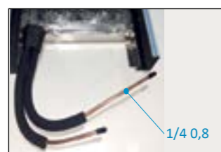
Evaporador interior en cobre 1/4 espesor 0.8 mm. Sujeción a la base con cinta adhesiva de maya y tira de chapa Inox soldada con puntos.
